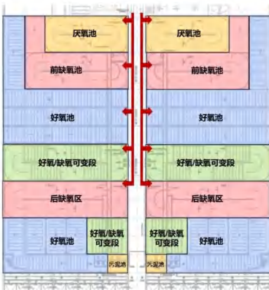
图 3.10-4b 本项目多模式可变的 AAO-AO 工艺生化池
